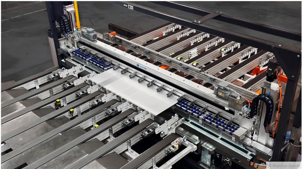
Der Evomat Evo 501 reinigt die Platinen vor der Presse bei hoher Transportgeschwindigkeit.
