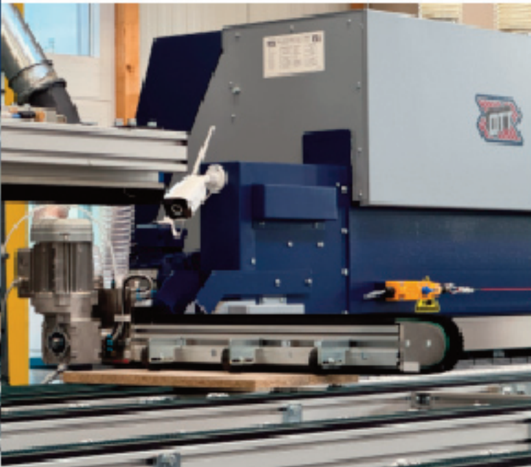
► Bei Paul Ott werden die Möbelplatten in der Kantenbearbeitungslinie mit einer Mikrofilament-Schwertbürste von Wandres gereinigt.
