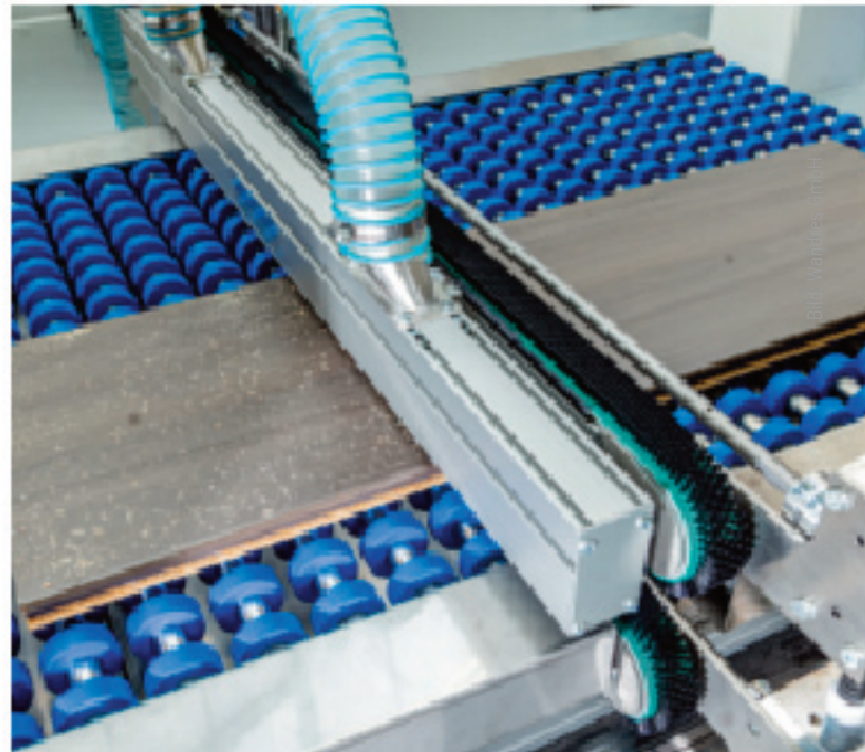
► Zur Vorreinigung kann eine Trans-Vac-Unit TKL 46 vorgeschaltet werden, die groben Schmutz vor der Bürste absaugt.
