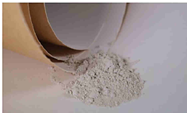
Papierstaub kann zu gravierenden Fertigungsproblemen führen. Geeignete Reinigungsmaschinen entfernen enorme Mengen Staub von der Papierbahn.
