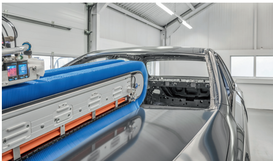
Im Technikum des Herstellers wird das Verfahren getestet und eine Karosserie gereinigt. Fotos: Wandres
