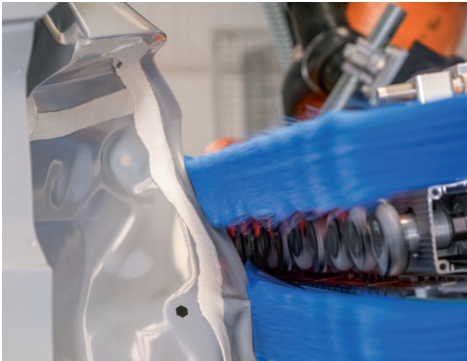
Zwischen den beiden Linearbürsten ist eine Reihe rotierender Tornadodüsen für die lufttechnische Reinigung angeordnet.
