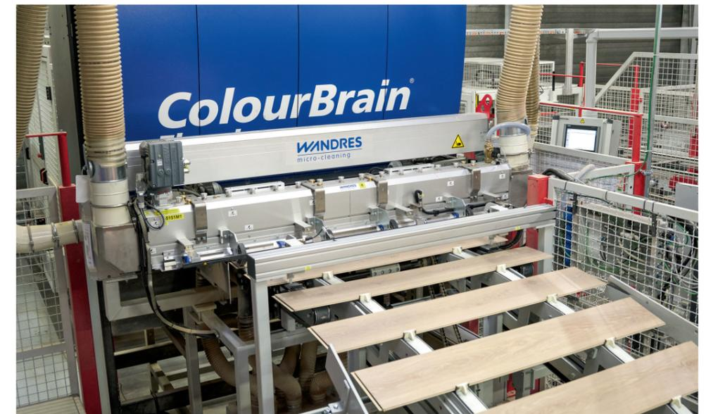
Abbildung 6: Reinigung vor der Kamerainspektion. Einlaufseitig ist der Tornado-Channel TKR zu sehen
