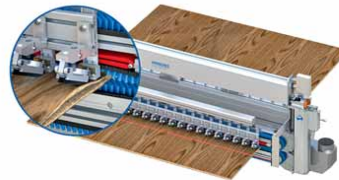
Die Kombi-Schwertbürste mit Tast-Steuerelementen im Einlauf und einer berührungsfreien beidseitigen Reinigung im Auslauf wurde speziell für Spanplatten nach der Kurztaktpresse entwickelt
