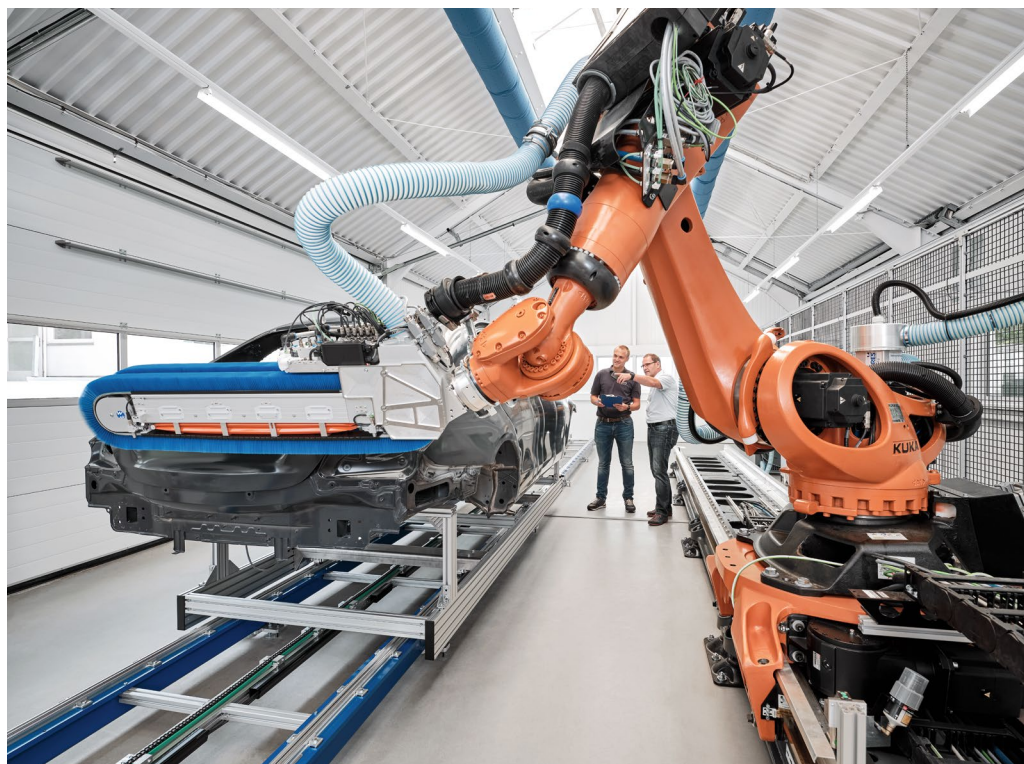
Bild 1 > Im Technikum in Wagensteig können Automobilhersteller Reinigungsversuche an eigenen Karosserien durchführen lassen.
