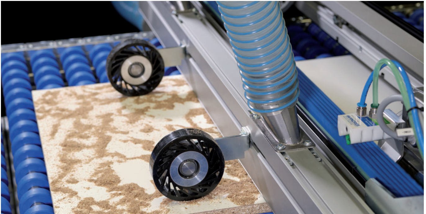
Der leistungsstarke Absaugkanal beseitigt große Partikelmengen und entlastet die nachgeschaltete Schwertbürste, die den verbliebenen Feinstaub entfernt.
