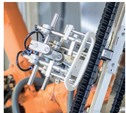
Robotergeführte Reinigung an einer Schwertbürste.
