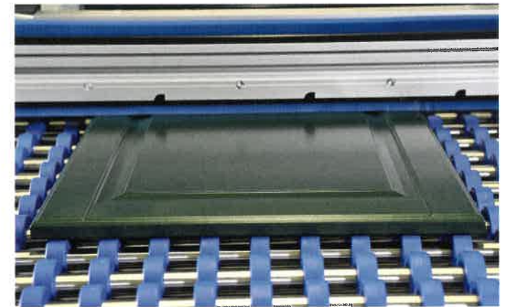
Für ein optimales Reinigungsergebnis entfernt eine Schwertbürste im Anschluss an die lufttechnische Reinigung den verbliebenen Feinstaub
