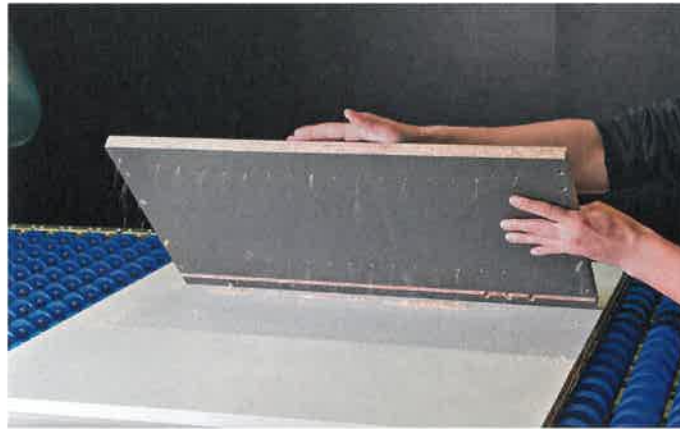
An einer ungereinigten Platte fallen beim Klopfest viele Späne aus den Bohrlöchern
