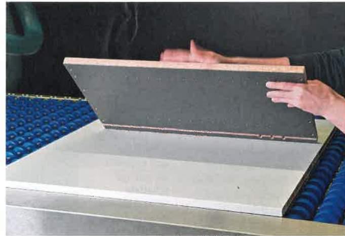
Nach der Reinigung mit dem „Tornado-Channel TKF“ fallen keine Späne mehr aus den Bohrlöchern
