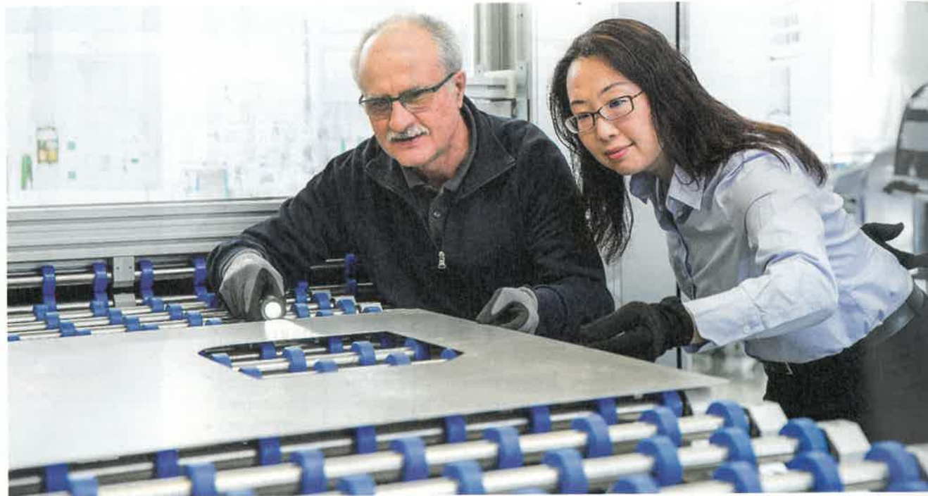
Im Schräglicht sind Partikel auf Platinen mit bloßem Auge sichtbar. Vor der Umformung müssen diese vollständig entfernt werden.
