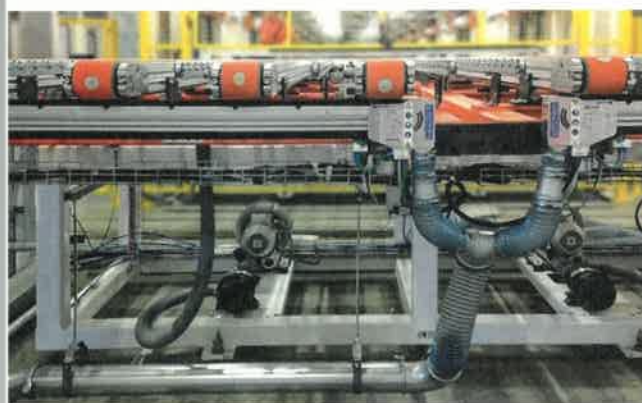
Vakuumförderbänder werden permanent von unten gereinigt, um ein Verschleppen von Partikeln auf die Platinen zu vermeiden.
