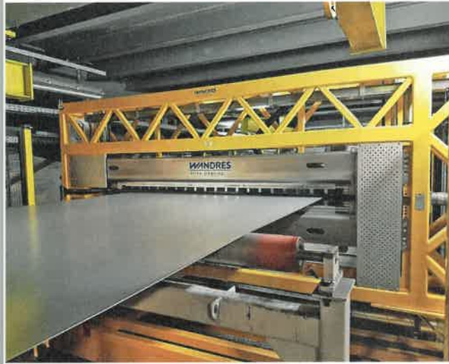
Coilware wird in einer Verzinkerei mit der Reinigungsmaschine Cevomat wischtechnisch gereinigt.
