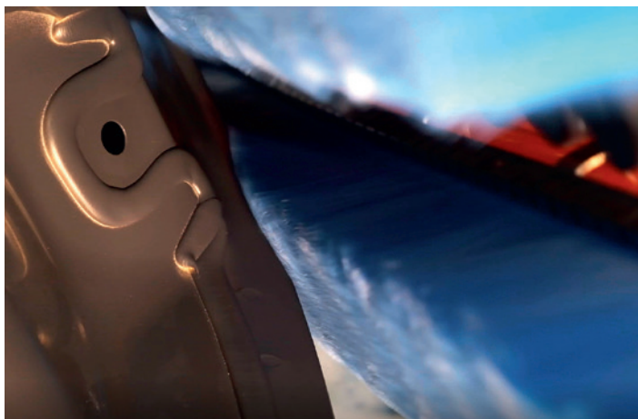
Die frisch aufgetragenen PVC-Nähte werden von der Bürste nicht berührt, dieser Bereich jedoch von den Tornadodüsen lufttechnisch gereinigt.
