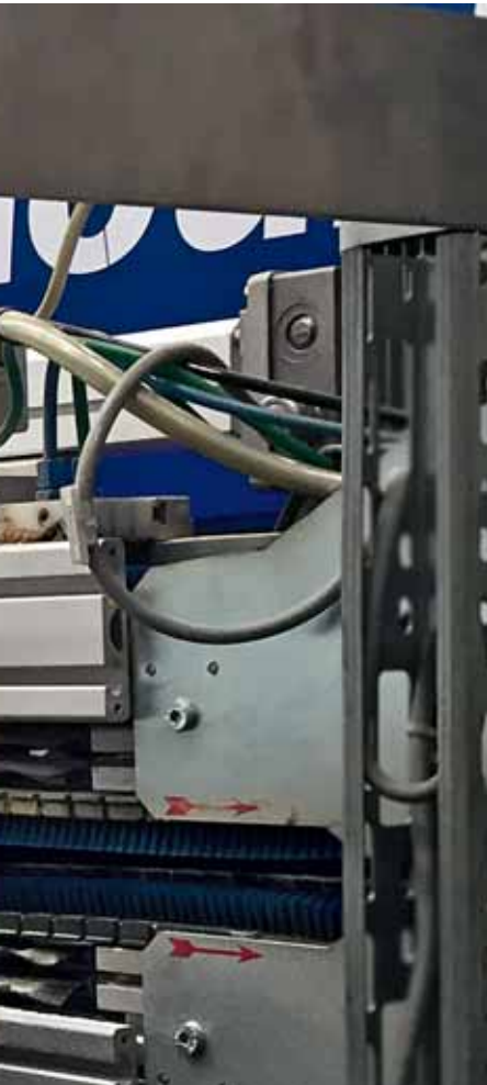
Beidseitige Reinigung einer direktbeschichteten Spanplatte vor der Kamerainspektion (Grafiken, Fotos: Wandres)
