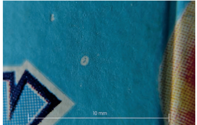
Abb. 2: Die sogenannte Butzenbildung ist ein typischer Fehler, der durch Papierstaub verursacht wird.
