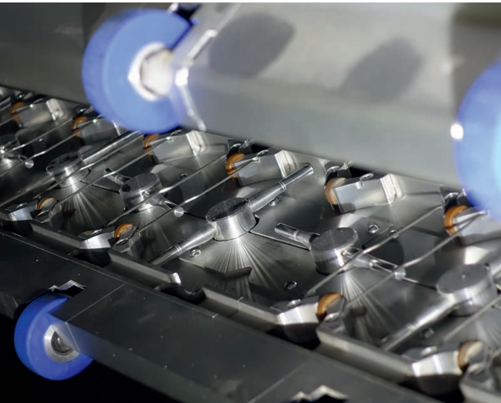
Lufttechnisches Reinigungsaggregat mit Blick auf die Drehdüsen im Tornado-Channel
