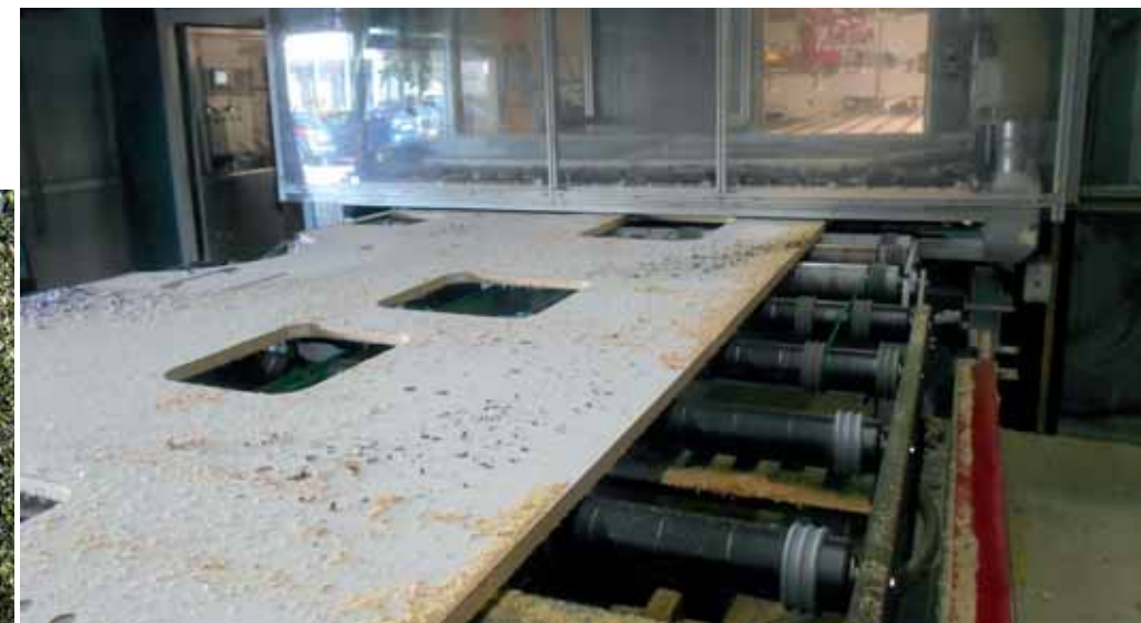
Ein Wandelement mit ausgefrästen Fensteröffnungen vor der Reinigung (Fotos: Wandres)
