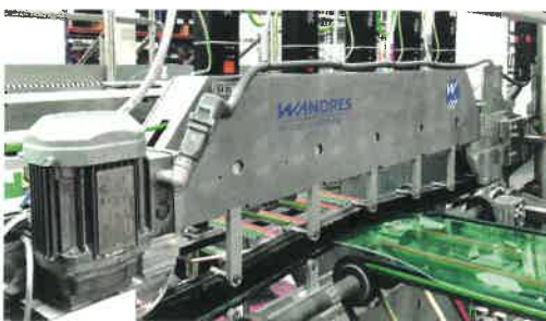
Die Kombi-Schwertbürste Una GV reinigt gebogene Glas-scheiben vor der Kamera-Inspektion. Bei stärker gewölbten Gläsern kommen robotergeführte Schwertbürsten zum Einsatz.
