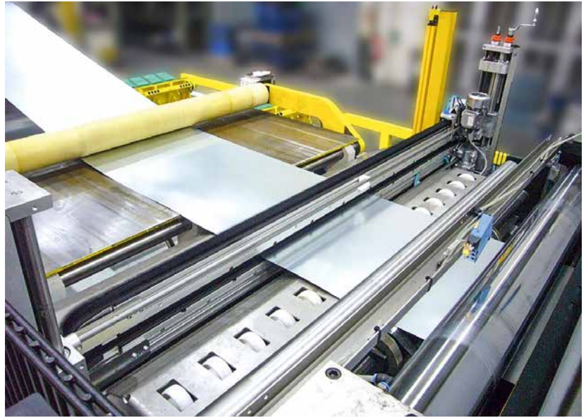
Eine Kombi-Schwertbürste reinigt die Ober- und Unterseite eines Stahlbandes.
