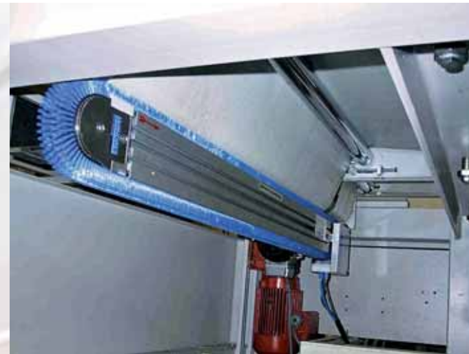
Ein Förderband wird unterhalb der Transportebene von einer Schwertbürste gereinigt (Fotos, Abb.: Wandres)
