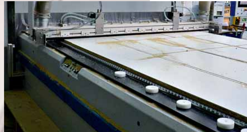
Eine Schwertbürste reinigt die Platten im Eingriffsbereich des Wendekegels (rechts)
