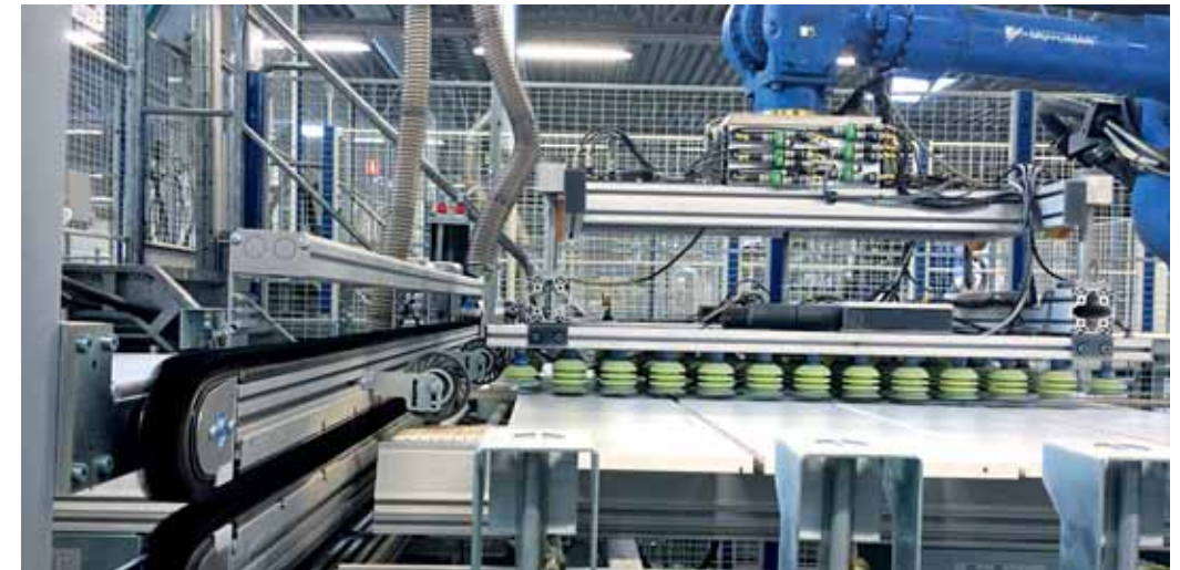
Nach der Aufteilsäge befinden sich große Mengen Späne auf der Plattenoberfläche, die durch einen Tornado-Channel entfernt werden
