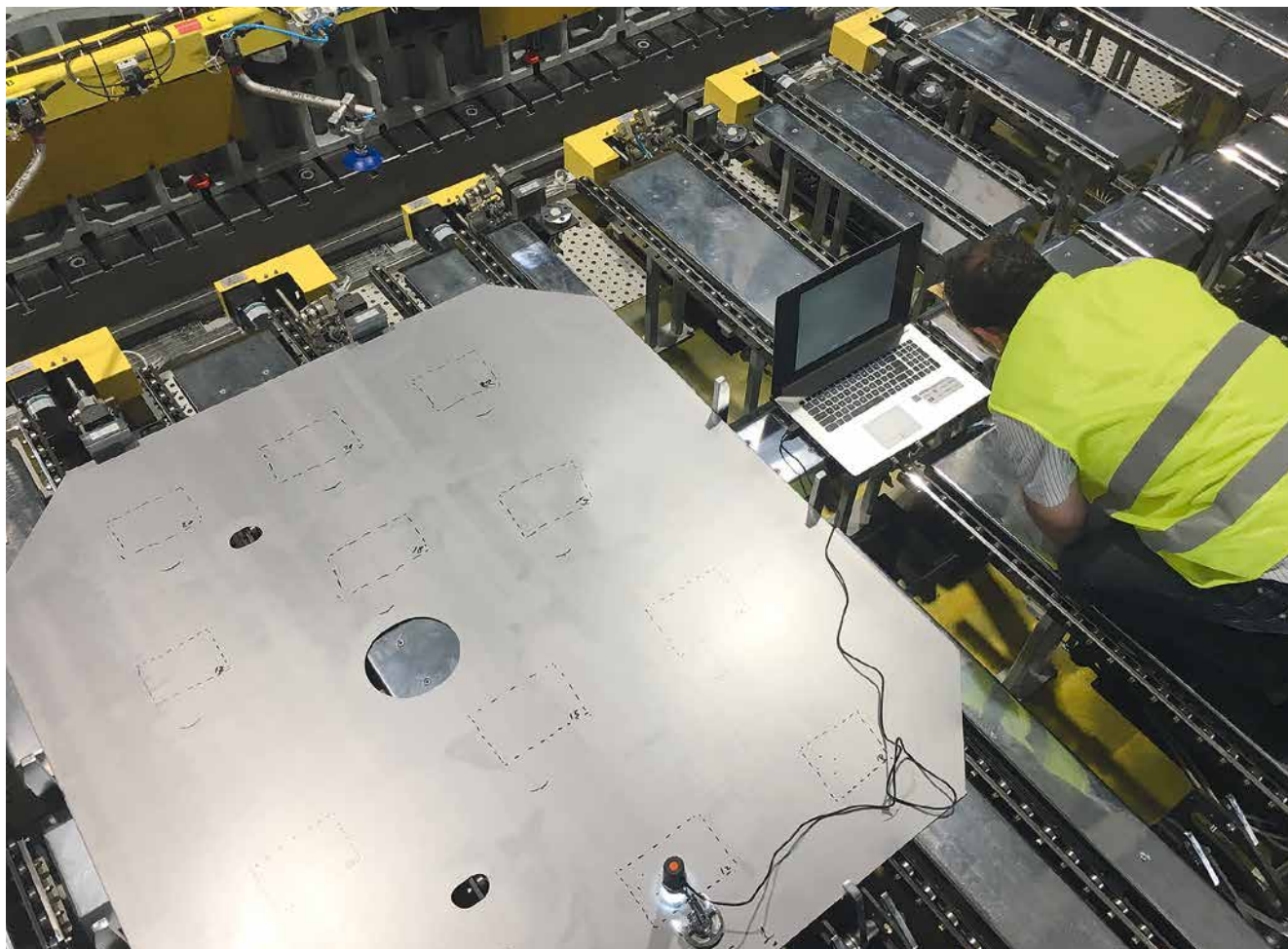
Durch die effiziente und wartungsarme Reinigungstechnik mit Schwertbürsten entfällt der kostenintensive Betrieb von Waschmaschinen. Im Bild zu sehen: Die Auswertung des Reinigungsergebnisses beim Automobilhersteller.
